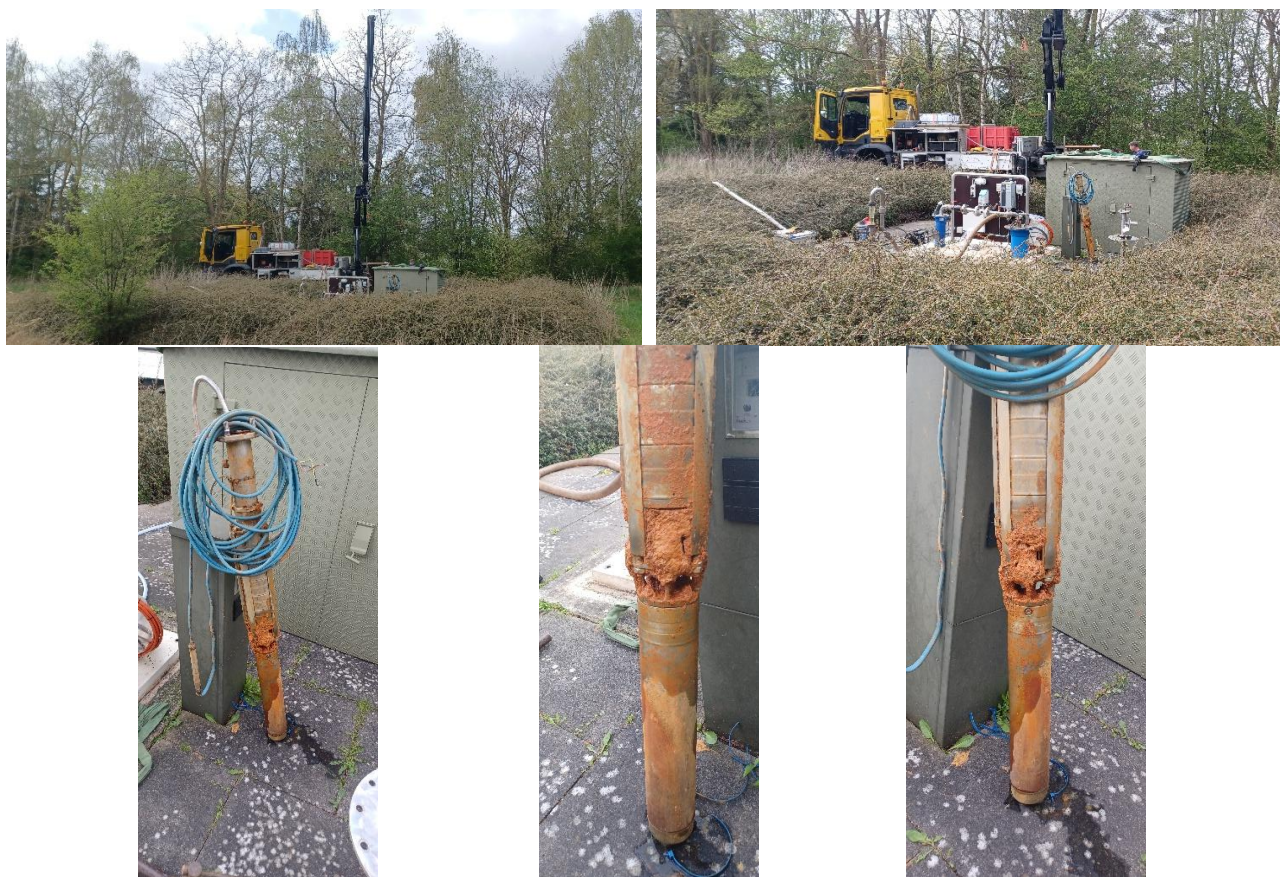
Pumpe fra boring nr. 6 tilstoppet af okker
